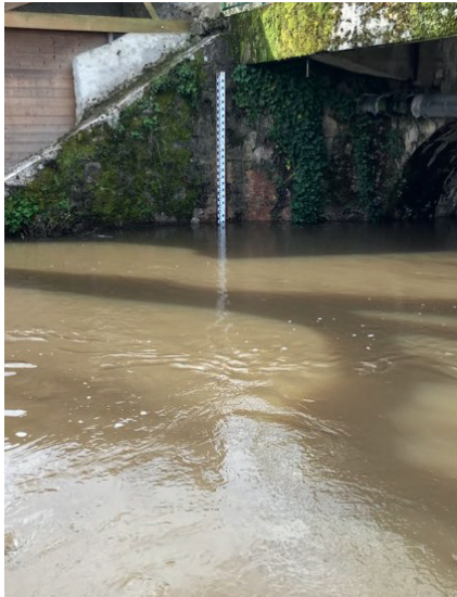
Installation d'une échelle de crue au Pont de Beignon.
